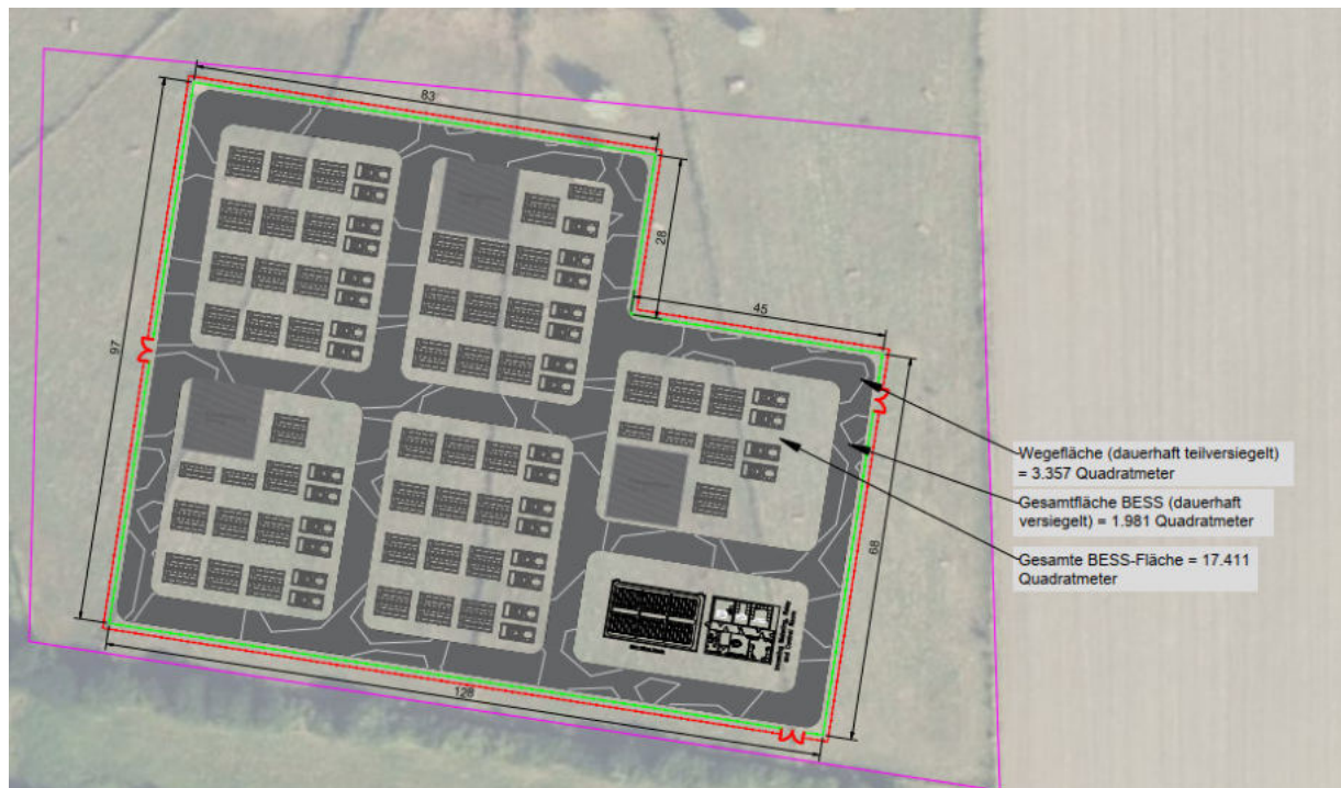
Abbildung 14: Beispielhafte Anordnung einer Großbatteriespeicheranlage
