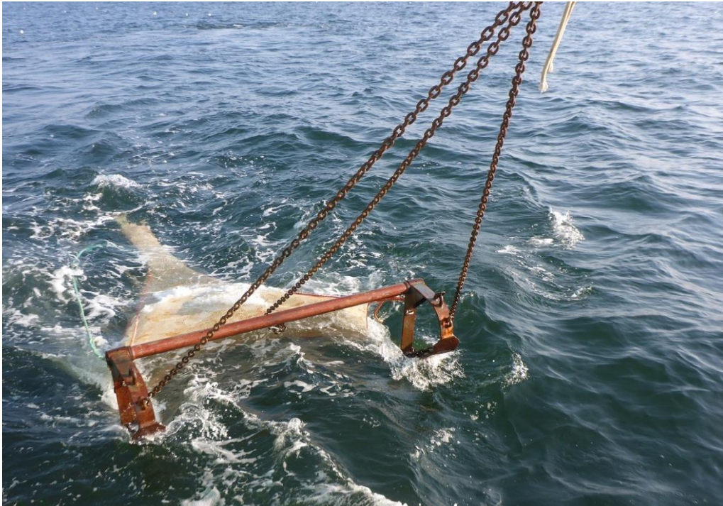
Abb. 6: 2 m-Baumkurre für die Erfassung der Epifauna und der kleineren demersalen Fischfauna.
