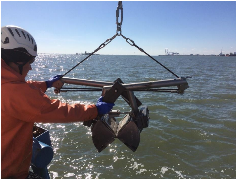
Abb. 4: Van-Veen-Greifer (0,1 m 2 Fläche) für die Erfassung der Infauna.
