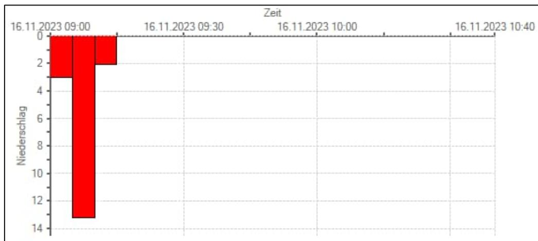
Abb. 4: Modellregen EULER II  $n=0,2$   $D=15\text{min}$
