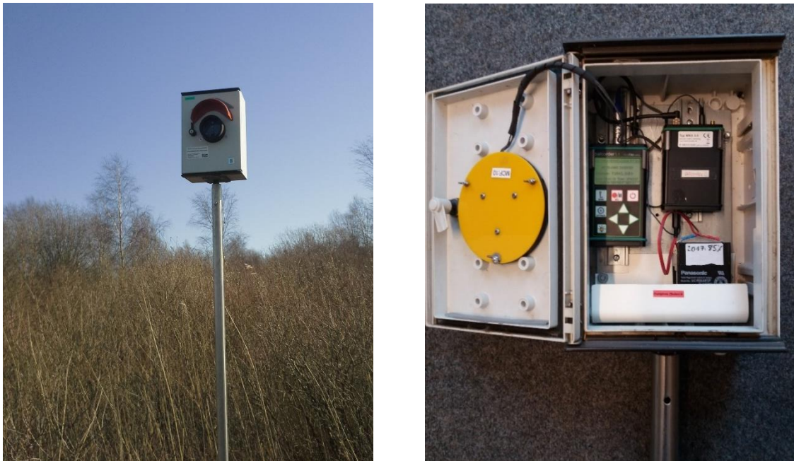
Abb. 3: Vorrichtung für die akustische Dauererfassung mit einem Batcorder in Bodennähe – Außenansicht und Innenansicht
