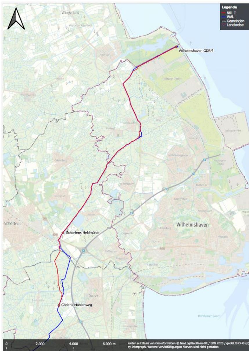
Die Open Grid Europe GmbH plant die Errichtung und den Betrieb der Wasserstoffleitung Nr. 502 H2ercules Nordsee-Ruhr-Link (NRL I) von Wilhelmshaven nach Dykhausen.
